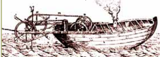
Паровой буксир с кормовым гребным колесом из английского патента Джонатана Хула 1736 года
