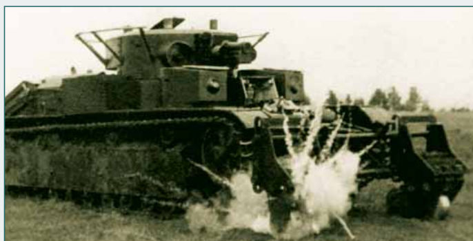
Испытания Т-28 с навесным противотанковым тралом на полигоне НИБТ
