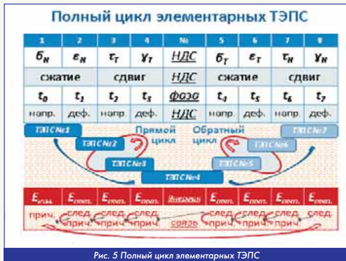
Рис. 5 Полный цикл элементарных ТЭПС
