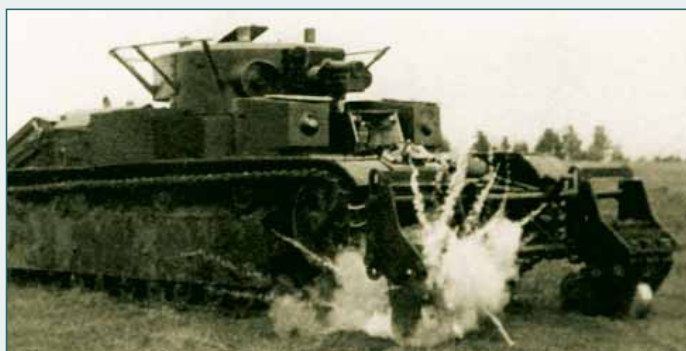
Испытания Т-28 с навесным противотанковым тралом на полигоне НИИТ
