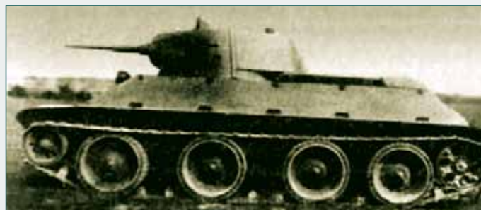
Опытный образец колёсно-гусеничного танка А-20 во время испытаний на полигоне в Кубинке, 1939 г.
