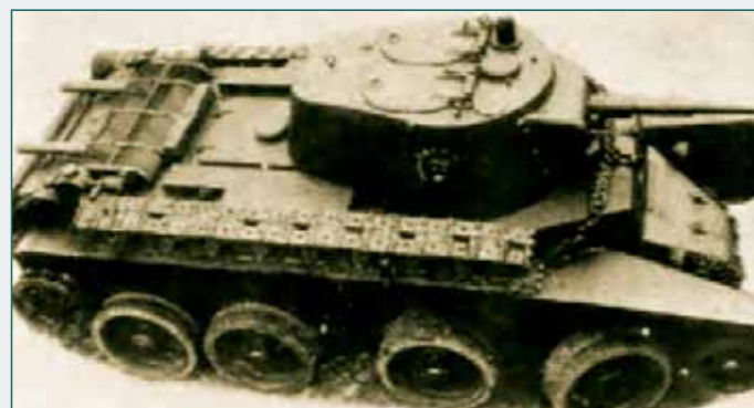
BT-7М с дизелем мало чем отличался от BT-7. Главное внешнее отличие - отсутствие «лепешки» пылеуловителя
