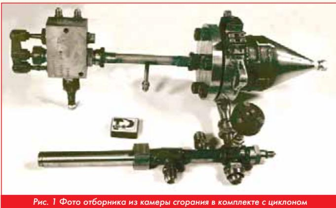
Рис. 1 Фото отборника из камеры сгорания в комплекте с циклоном
