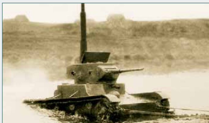
Испытание танка Т-26 с оборудованием для преодоления водных преград по дну (1935 г.). Все отверстия и люки машины закрывали деревянными вставками и резиновыми уплотнителями, а в башню устанавливали трубу для подачи воздуха из атмосферы. Максимальная глубина водной преграды 5 м была обусловлена примененным методом герметизации и длиной трубы для подачи воздуха в танк
