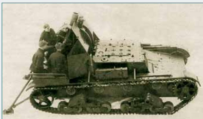
СУ-5-3 вооружалась 152,4-мм дивизионной mortирой обр. 1931 г. (длина ствола 9,3 калибра). Начальная скорость снаряда 250 м/с. Углы вертикального наведения составляли от 0° до +72°, углы наведения по горизонтали - в секторе 12° без поворота машины. Максимальная дальность стрельбы составляла 5285 м. Скорострельность 4-5 выстр./мин. на углах возвышения до 30°, свыше 30° - 1 выстр./мин. Боекомплект составлял 4 выстрела
