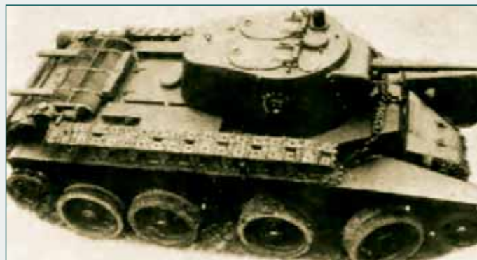
BT-7M с дизелем мало чем отличался от BT-7. Главное внешнее отличие - отсутствие «лепешки» пылеуловителя
