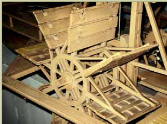
Гребное колесо верповального судна конструкции Кулибина
