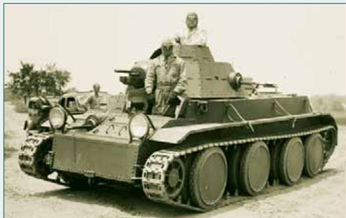
**Американский средний колесно-гусеничный танк Т3Е2.** Создан как одна из версий танка "Кристи" М1931, главным преимуществом которого была высокая скорость, достигавшая, по разным данным, от 92,8 до 111 км/ч на колесах и до 65 км/ч на гусеницах. Вооружение, монтировавшееся в восьмигранной башне, состояло из одной 37-мм пушки и пяти 7,62-мм пулеметов. Было изготовлено три Т3Е2 для испытаний, которыми все и закончилось...
