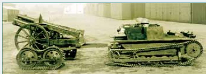
«Карден-Ллойд» Mk. VI буксирует 94-миллиметровую гаубицу
