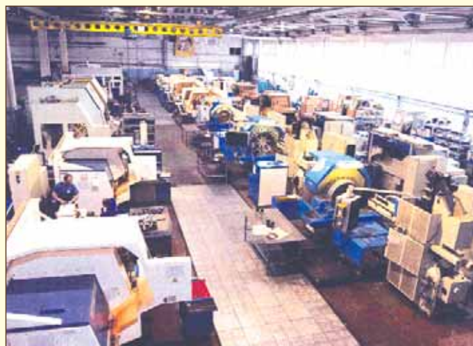
Рис. 4 Участок токарно-лобовых станков с ЧПУ обработки дисков компрессора, турбины и кольцевых деталей
