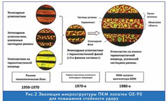
**Рис.2 Эволюция микроструктуры ПКМ лопатки GE-90 для повышения стойкости удара**
