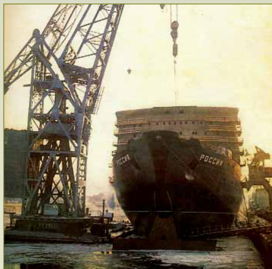
Установка первого блока надстройки на атомный ледокол «Россия»
