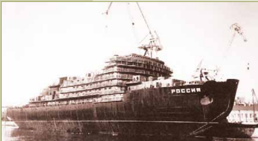
Установка первого блока надстройки на атомный ледокол «Россия»
