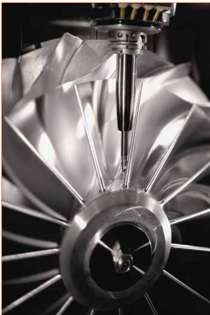
Процесс изготовления центробежной ступени компрессора
