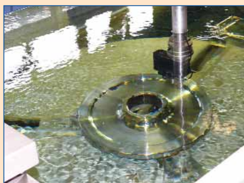
Ультразвуковая дефектоскопия заготовки диска турбины
