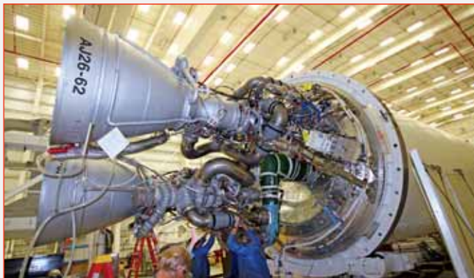
Установка AJ26-62 - модернизированного варианта НК-33 - на РН "Антарес"
