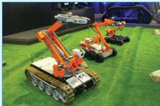
Большое количество робототехнических комплексов - военного назначения (разведывательные, инженерные, постановки мин и напротив - разминирования, транспортные), предназначенных для работы в условиях чрезвычайных ситуаций разного рода, летающие и плавающие.
