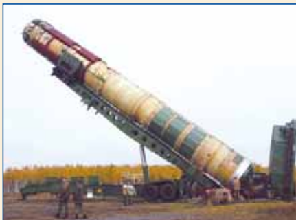
Установка Р-36М2 в шахту
