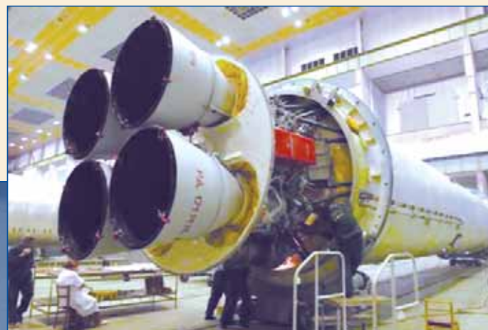
Установка двигателя РД171М на РН "Зенит"
