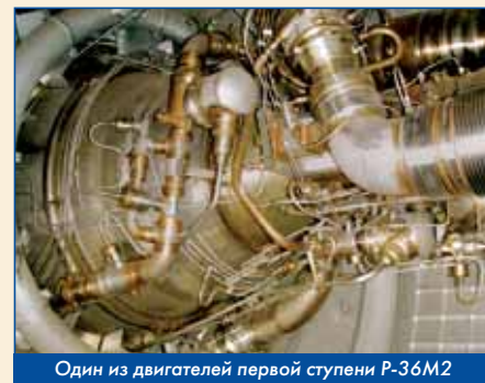
Один из двигателей первой ступени Р-36М2
