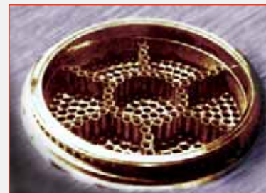
Схема расположения форсунок смесительной головки РД170. Выступающие форсунки образуют антипульсационные перегородки
