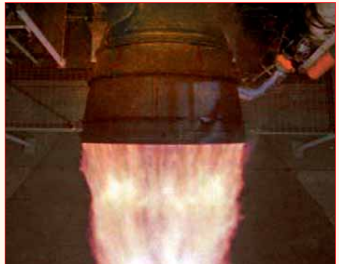
Рис. 6 Вихри Тейлора-Гёртлера на срезе сопла РДТТ
