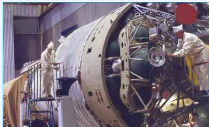
Сборка орбитальной военной станции Алмаз
