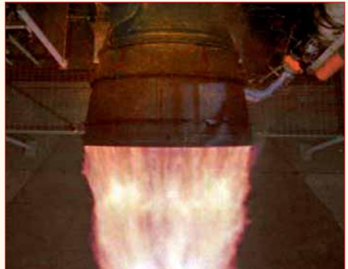
Рис. 6 Вихри Тейлора-Гёртлера на срезе сопла РДТТ
