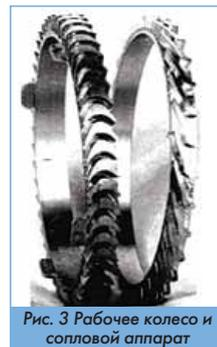
Рис. 3 Рабочее колесо и сопловой аппарат
