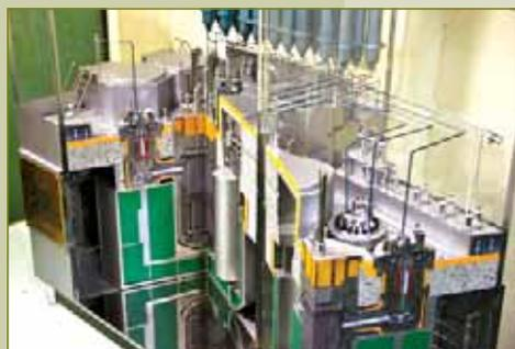
Макет атомной парогенераторной установки АЛ "Ленин"
