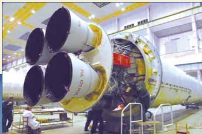
Установка двигателя РД171М на РН "Зенит"
