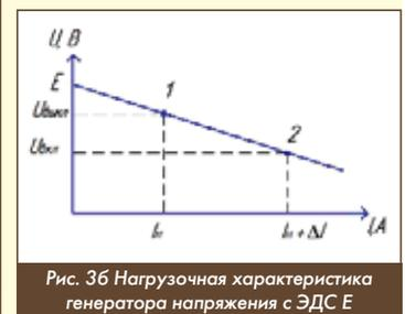
Рис. 3б Нагрузочная характеристика генератора напряжения с ЭДС E
