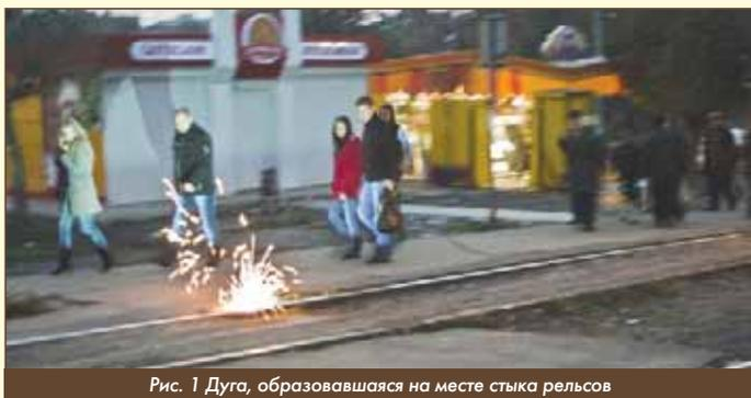
Рис. 1 Дуга, образовавшаяся на месте стыка рельсов
