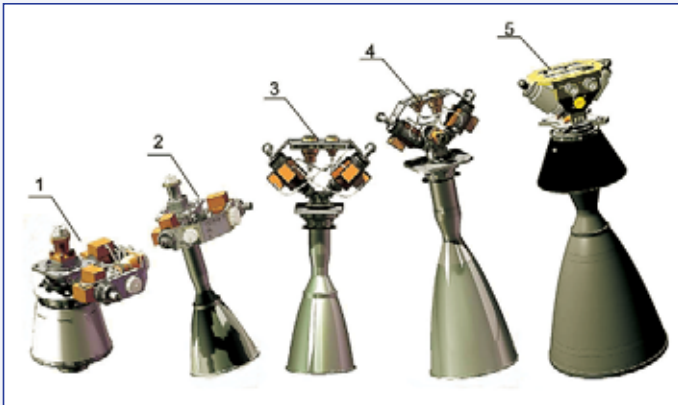
Рис. 2 ЖРДМТ разработки КБхимаш с дефлекторно-центробежной схемой смесеобразования: 1 - С5.142, тяга 25 Н (Jуд = 286 с); 2 - С5.145, тяга 50 Н (Jуд = 305 с); 3 - С5.144, тяга 100 Н (Jуд = 304 с); 4 - С5.146, тяга 200 Н (Jуд = 307 с); 5 - С5.165.00-0, тяга 400 Н (Jуд = 312 с)
