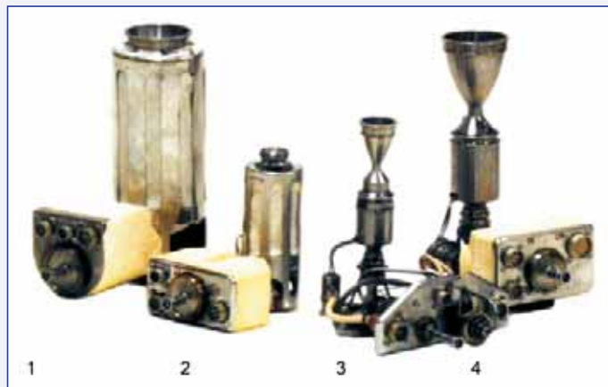
Рис. 5 Однокомпонентные ЖРДМТ разработки КБХиммаш: 1 - С5.221, тяга 50 Н (Иуд = 230 с); 2 - С5.216, тяга 10 Н (Иуд = 230 с); 3 - 255У.208, тяга 5 Н (Иуд = 230 с); 4 - 19А6 тяга 25 Н (Иуд = 234 с)
