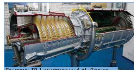
Двигатель ТР-1 конструкции А.М. Люльки
