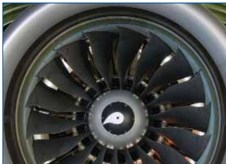
Рис. 4. Редукторный ТРДД Pratt&Whitney (geared turbofan) GTF
