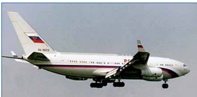
Рис. 5. Ил-96-550 - исследуемый двухпалубный вариант с ТРДД сверхвысокой степенью двухконтурности
