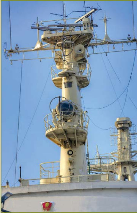
Грот-мачта. Она же вентиляционное устройство отсека парогенераторов Пост управления энергетикой атомного реактора: реакторами, парогенераторами, гребными электродвигателями
