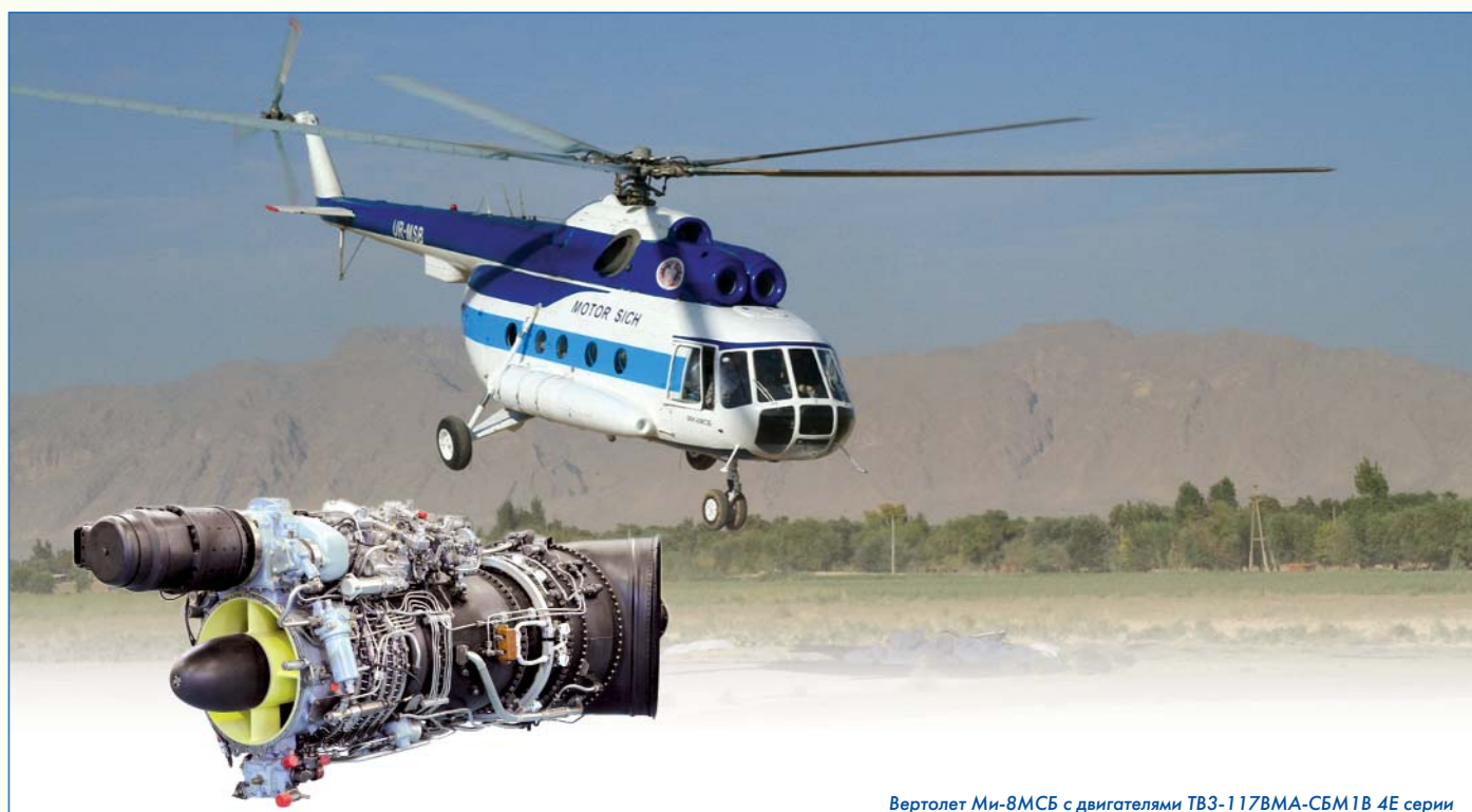
Вертолет Ми-8МСБ с двигателями ТВ3-117ВМА-СБМ1В 4Е серии
