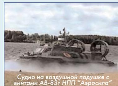
Судно на воздушной подушке с винтами АВ-83т НПП "Аэросила"
