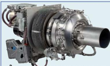
Вспомогательная силовая установка e-APU60 для вертолёта Agusta производства компании Microturbo
