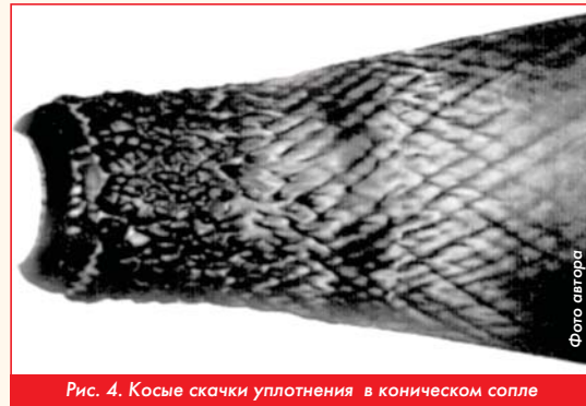
Рис. 4. Косые скачки уплотнения в коническом сопле
