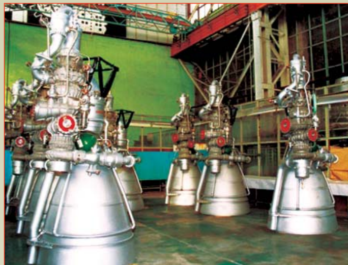
Двигатели НК-33, готовые к установке на РН
