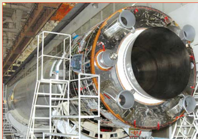
Первая ступень Союз-2.1в с двигателем НК-33
