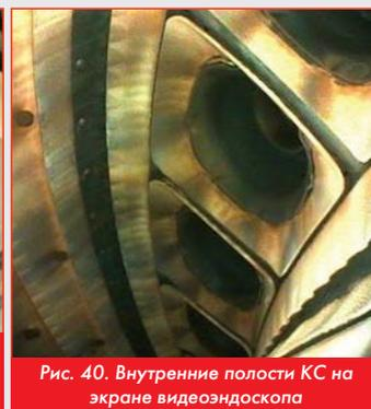
Рис. 40. Внутренние полости КС на экране видеоэндоскопа
