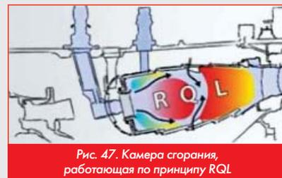
Рис. 47. Камера сгорания, работающая по принципу RQL
