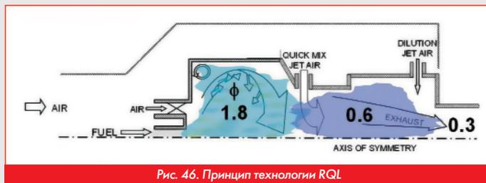
Рис. 46. Принцип технологии RQL
