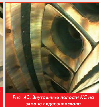
Рис. 39. Снимок внутренних поверхностей камеры сгорания, сделанный при помощи XLG0
