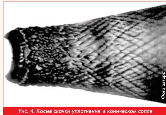
Рис. 4. Косые скачки уплотнения в коническом сопле
