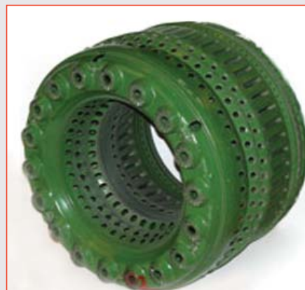
Рис. 36. Защитная стеклоэмаль на кольцевой КС
