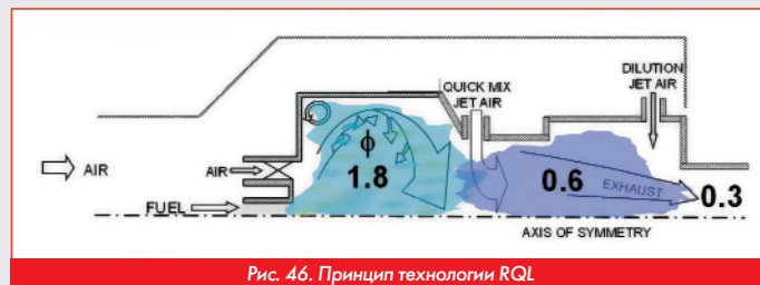
Рис. 46. Принцип технологии RQL
