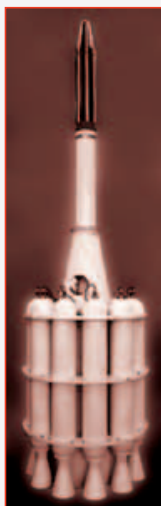
Макет ИСЗ "Эксплорер-1" с четвертой ступенью (вверху). Внизу вторая ступень, в центре которой размещена третья ступень. Справа - американские инженеры у макета спутника
