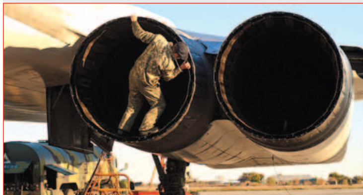
Рис. 19. Двигатели НК-32 на самолете Ту-160. Послеполетный осмотр
