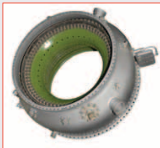
Рис. 18. Кольцевая камера сгорания двигателя НК-32 (самолет Ту-160)
