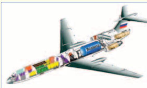
Компановка экспериментального самолёта Ту-155
