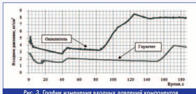
Рис. 3. График изменения входных давлений компонентов
