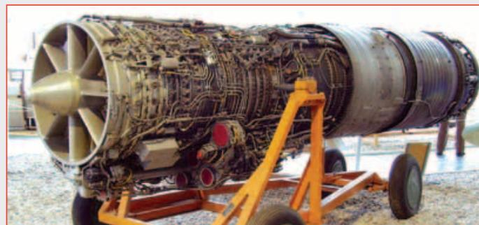
Рис. 14. Двигатель АЛ-21Ф-3 (компоновка С) для самолетов Су-17М
