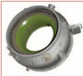
Рис. 18. Кольцевая камера сгорания двигателя НК-32 (самолет Ту-160)
