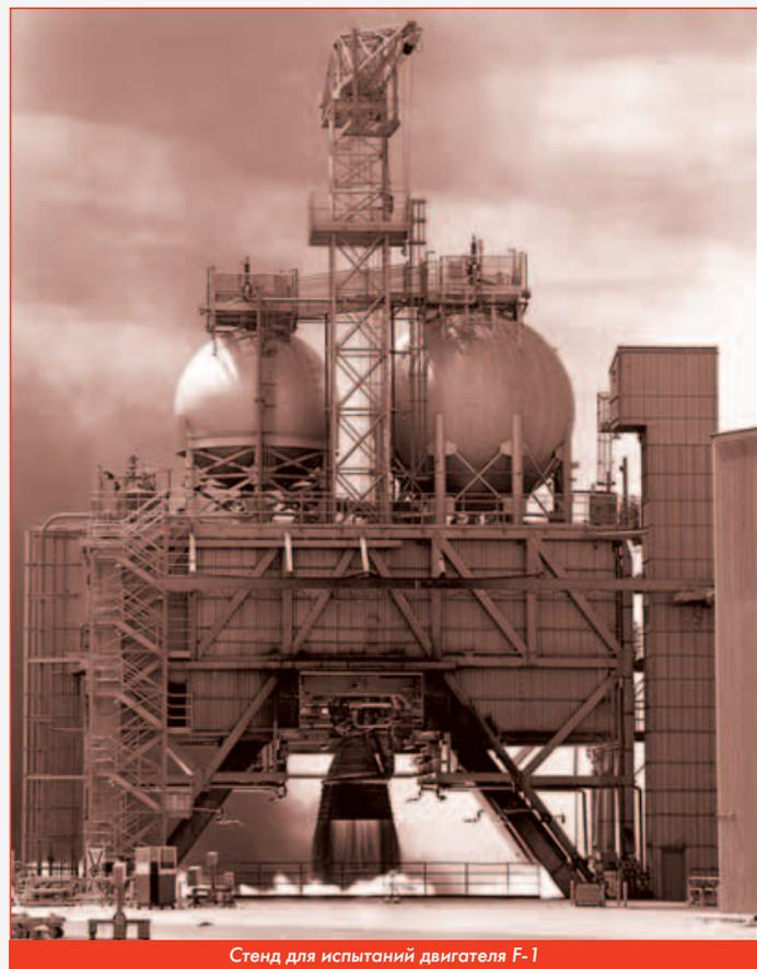
Стенд для испытаний двигателя F-1
