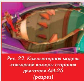
Рис. 22. Компьютерная модель кольцевой камеры сгорания двигателя AI-25 (разрез)
