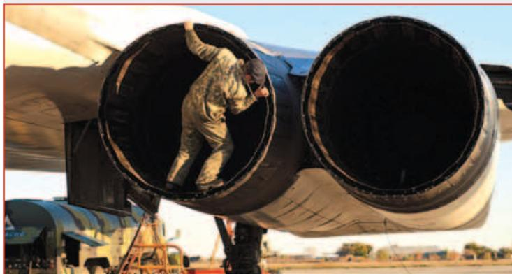
Рис. 19. Двигатели НК-32 на самолете Ту-160. Послеполетный осмотр
