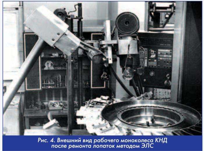
Рис. 4. Внешний вид рабочего моноколеса КНД после ремонта лопаток методом ЭЛС
