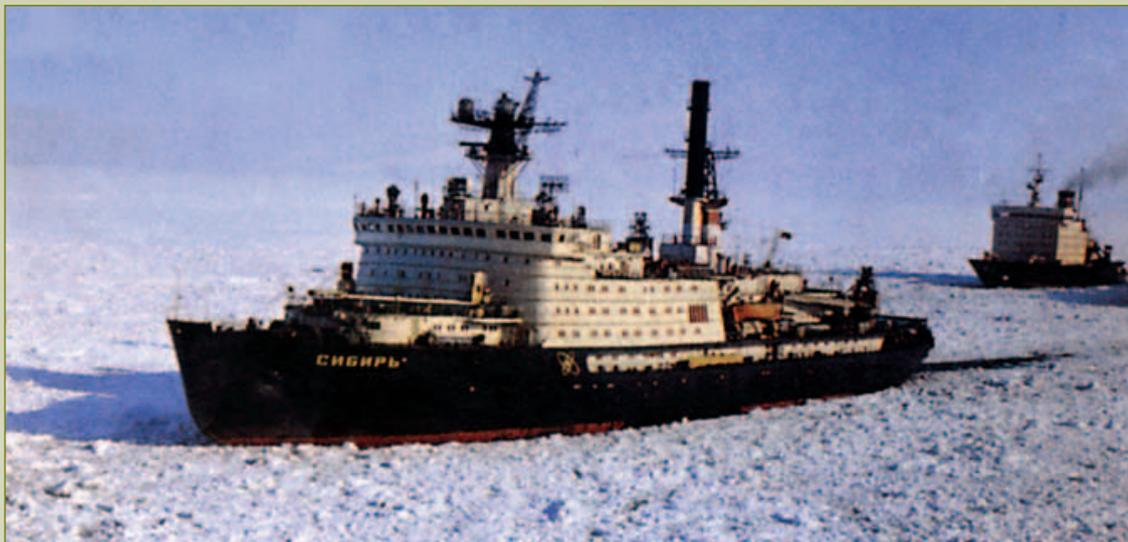
Атомный ледокол "Сибирь" 75 000 л.с. На заднем плане атомный ледокол "Таймыр" мощностью 50 000 л.с.
