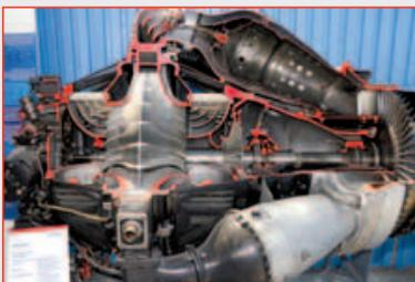
Рис. 9. РД-45 с трубчатой камерой сгорания
