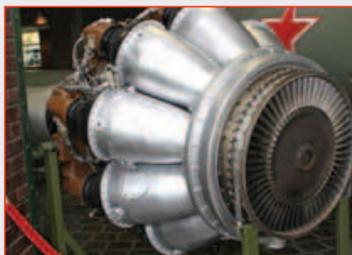
Рис. 8. Двигатель РД-45
