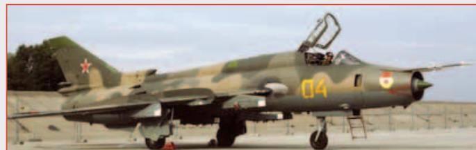
Рис. 15. Истребитель-бомбардировщик Су-17М4 с двигателем АЛ-21Ф3
