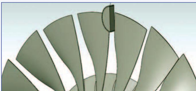
Рис. 2. Внешний вид лопатки моноколеса с вставкой
