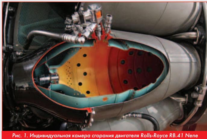
Рис. 1. Индивидуальная камера сгорания двигателя Rolls-Royce RB.41 Nene
