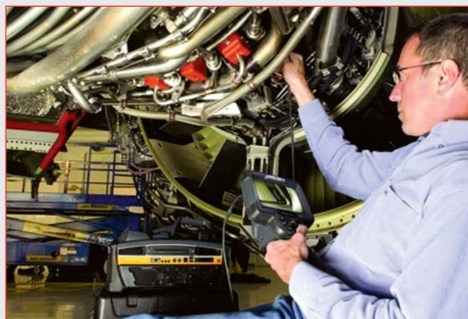
Рис. 27. Осмотр двигателя CFM56 с помощью видеобороскопа XLG3
