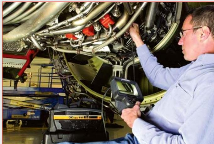
Рис. 27. Осмотр двигателя CFM56 с помощью видеобороскопа XLG3
