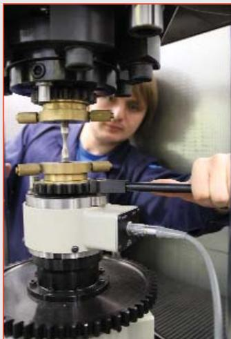
Подготовка образца к испытаниям на многоцикловую усталость
