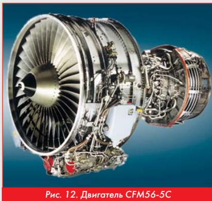
Рис. 12. Двигатель CFM56-5C
