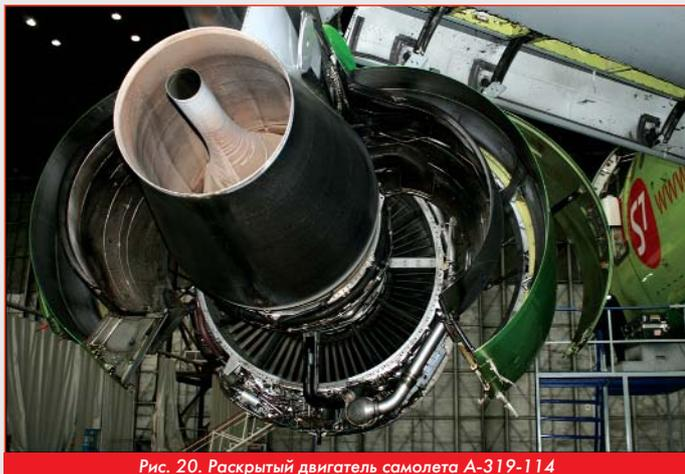
Рис. 20. Раскрытый двигатель самолета A-319-114
