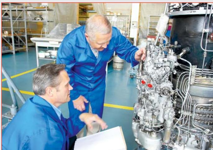
**Установка коробки агрегатов на двигатель**
