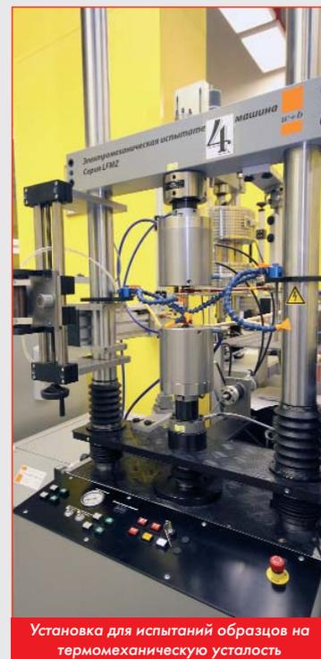
Установка для испытаний образцов на термомеханическую усталость
