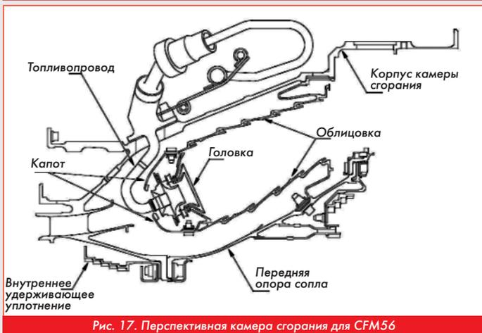
Рис. 17. Перспективная камера сгорания для CFM56
