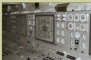
Пульт управления реакторами ледокола "Ленин"
