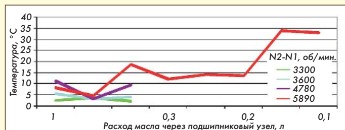
Рис. 4. Зависимость разности температур на поверхности подшипникового кольца и масла на входе в подшипниковый узел от величины расхода масла
