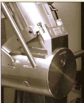
Рис. 5. Микрофокусная трубка на 450 кВ фирмы Nikon Metrology (X-Tek)
