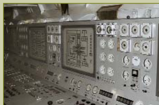
Пульт управления реакторами ледокола "Ленин"
