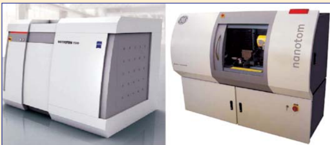
Рис. 6. Внешний вид микротомографической координатно-измерительной машины METROTOM 1500 фирмы Carl Zeiss (слева) и нанотомографа PHOENIX NANOTOM S&M фирмы GE Sensing & Inspection Technologies (Phoenix|x-ray)
