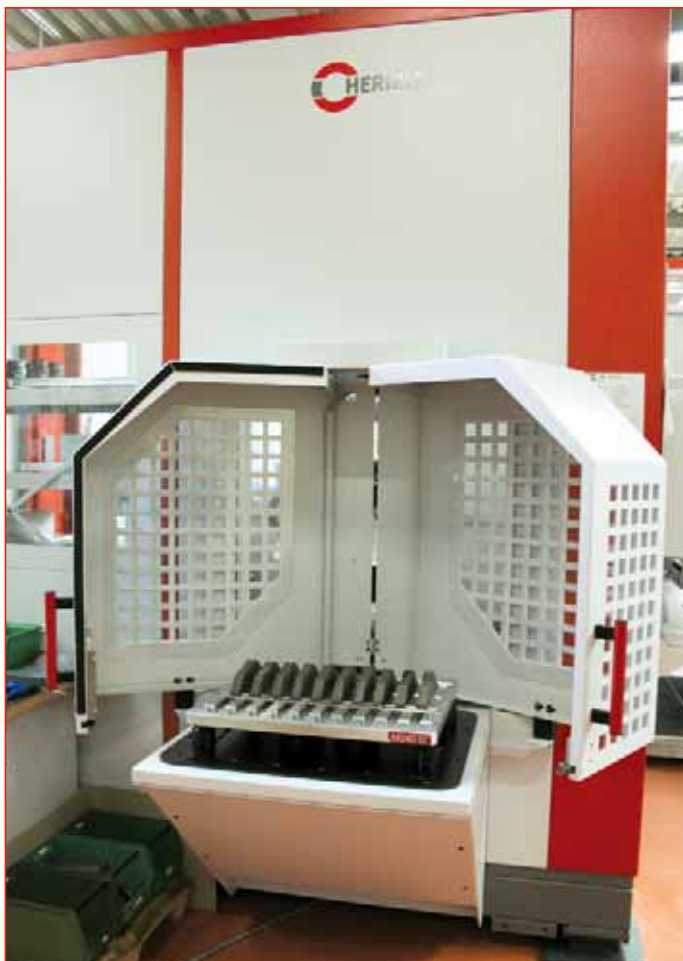
Рис. 3. Место смены заготовки на RS2 для параллельной основному времени погрузки/выгрузки паллет; собственные паллеты фирмы Mawates для многократного зажима грубо нарезанных заготовок
