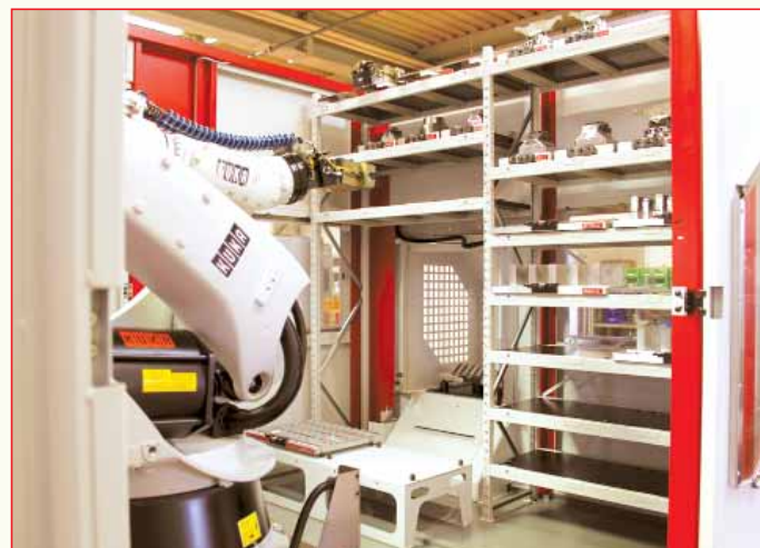
Рис. 2. Роботизированная система R52 со стеллажами для хранения паллет с различными по высоте зажимами заготовок; слева внизу можно увидеть отверстие на обратной стороне места смены заготовки
