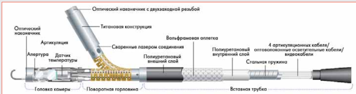
Рис. 3. Конструкция быстросъемных зондов QuickChange (изображение не соответствует реальному размеру зонда)
