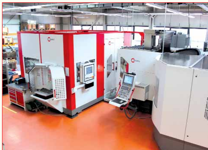
Рис. 1. Общий вид производственных систем Hermle в компании Mawates AG, состоящей из С 30 U (справа) и роботизированной системы R52 для хранения и управления паллетами/детальями
