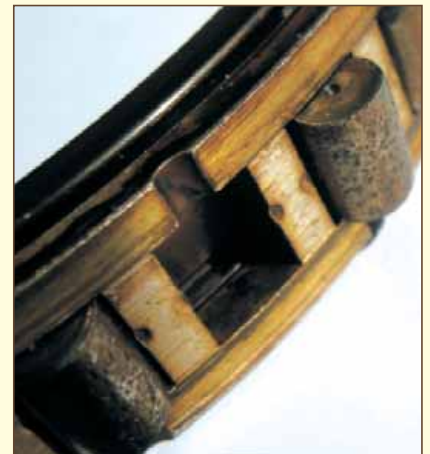
Рис. 3. Состояние сепаратора и роликов подшипника после длительной эксплуатации
