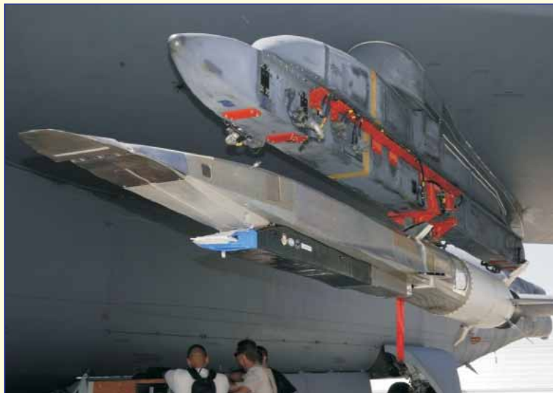
Рис. 2. Демонстрационный образец ГЛА X-51A на подвеске стратегического бомбардировщика B-52H перед проведением летных испытаний
