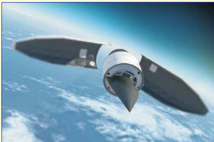
Рис. 3. ГЛА Falcon HTV-2 (слева представлена концепция, справа - экспериментальный гиперзвуковой планер)
