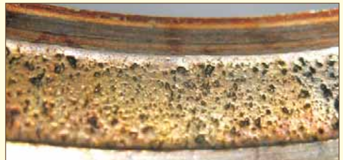
Рис. 2. Состояние дорожки наружного кольца подшипника после длительной эксплуатации
