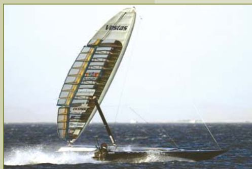
Это гибридное судно-глиссер Vestas Sailrocket, как и Sailrocket 2, разработки австралийского виндсёрфера Пола Ларсена, предназначено для установления мирового рекорда скорости на 500-метровой дистанции. Так как здесь направление движения не меняется, то и нет необходимости в установке второго крыла по схеме Ю.В. Макарова
