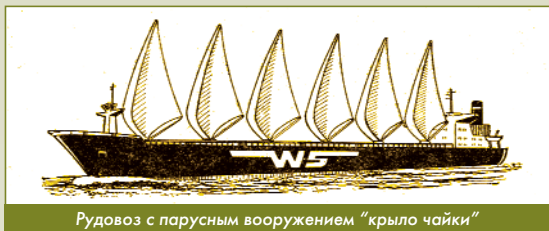
Рудовоз с парусным вооружением "крыло чайки"
