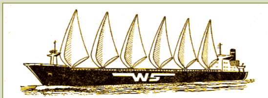
Рудовоз с парусным вооружением "крыло чайки"
