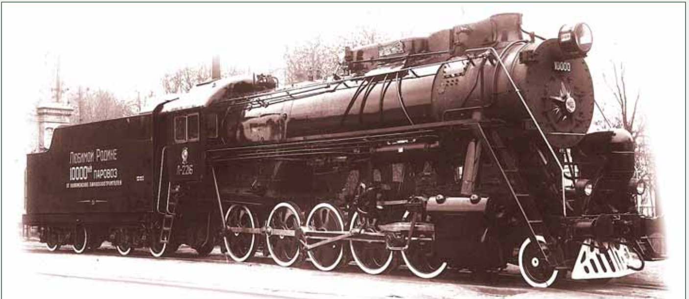
Грузовой паровоз (1-5-0, тип ПЗ2)
