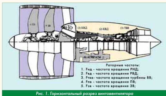
Рис. 1. Горизонтальный разрез винтовентилятора
