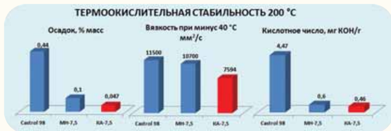
Рис. 3. Сравнение эксплуатационных свойств масла КА-7,5 и отечественных и зарубежных аналогов
